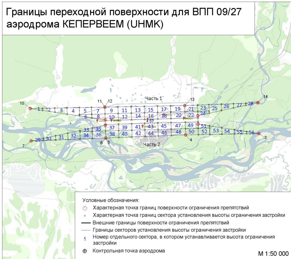
Рисунок 4.2. Схема границ переходной поверхности с учетом летной полосы для ВПП 09/27
