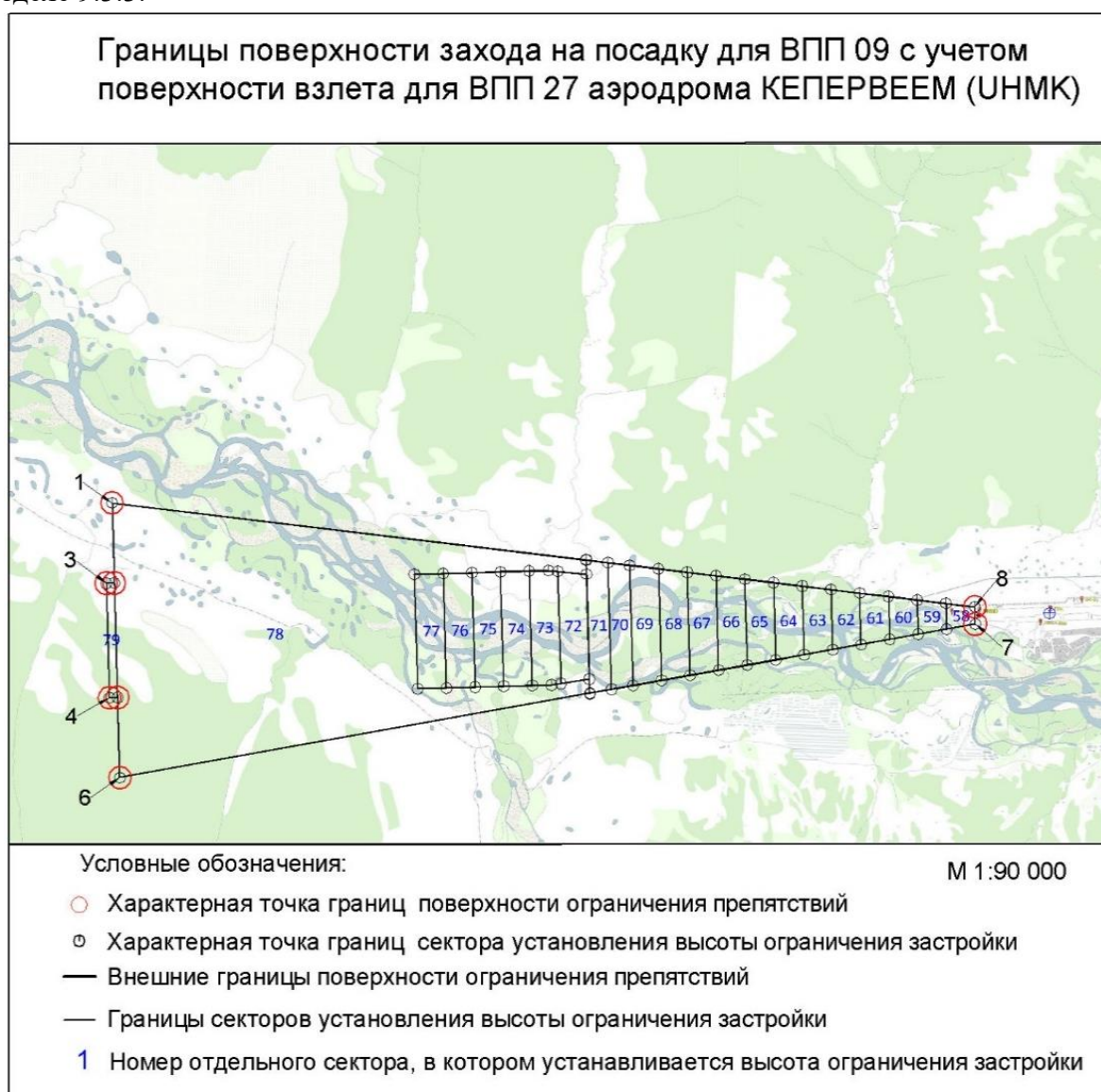
Рисунок 4.3. Схема границ поверхности захода на посадку для ВПП 09 с учетом поверхности взлета ВПП 27
