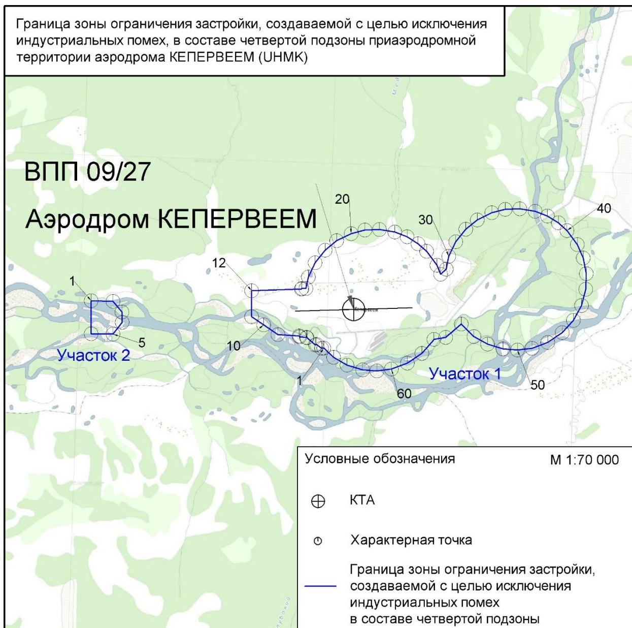
Рисунок 5.2. Схема зоны ограничения застройки, создаваемой с целью исключения промышленных помех, в составе четвертой подзоны
