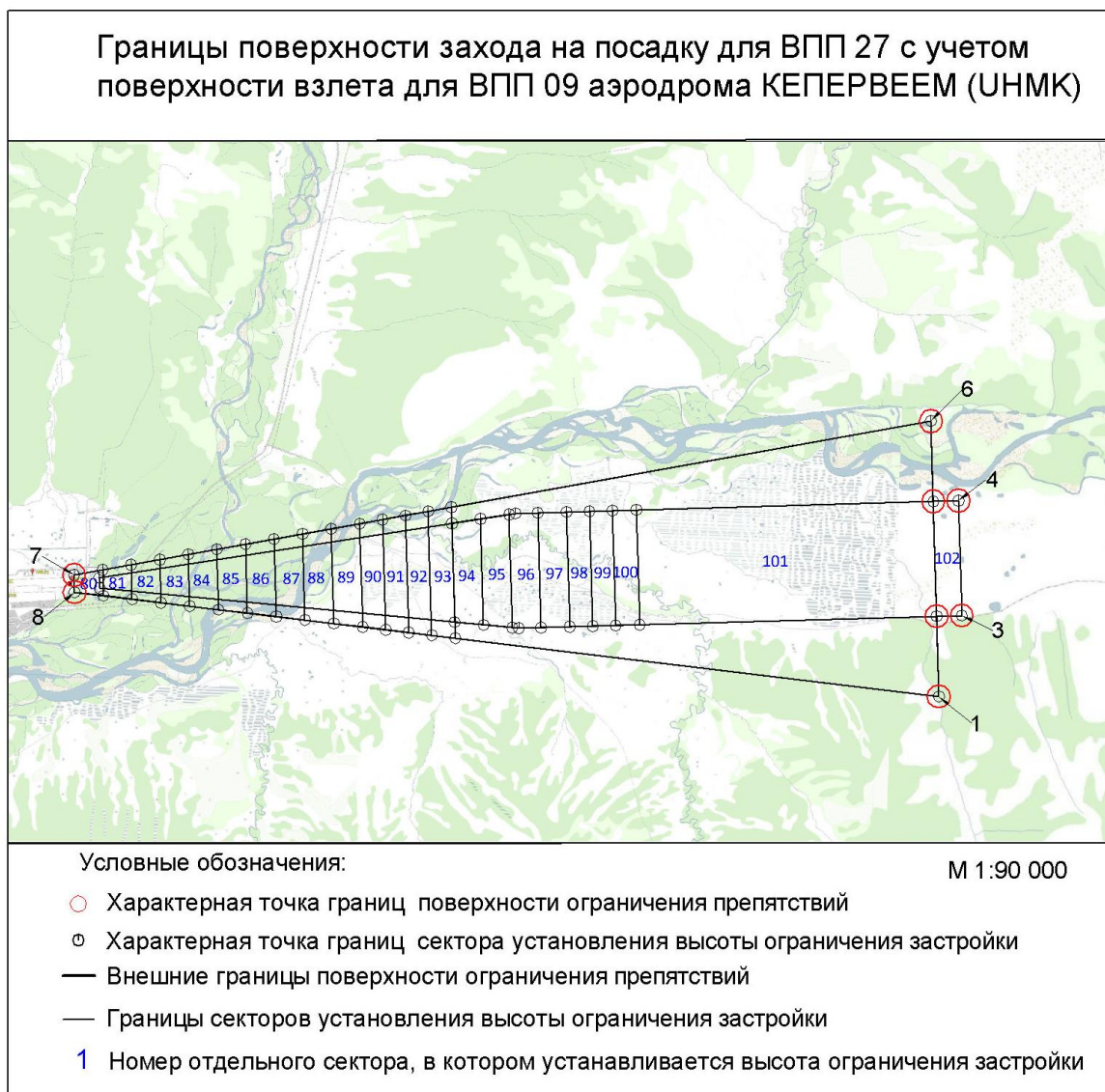
Рисунок 4.4. Схема границ поверхности захода на посадку для ВПП 27 с учетом поверхности взлета ВПП 09
